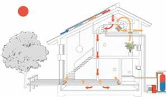
晴天時には屋根で集めた太陽の熱を室内に取り込んで暖房します。給湯はヒートポンプを利用して行います。
