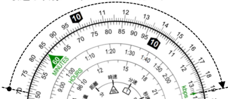
外目盛をファイルサイズ、内目盛を時間に対応させ、内目盛のkbpsを見ると19.1あたりを指しています。常識的に1,910kbpsが答えとなりますが、これは総合ビットレートなので、実際は例えば音声の128kbpsを引いて1,782kbpsが映像のビットレートとなります。純粹なVBRではアテになりませんが、目標ビットレートを指定して圧縮する動画の場合は、CBRとほぼ同等とみなすことが可能です。
