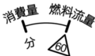
航空機は向かい風・追い風の影響で飛行距離が変わるので、距離に対する燃費ではなく、運行時間に対する燃費を計算します。燃料消費量・所要時間(分)・燃料流量のうち2つの要素を使います。
