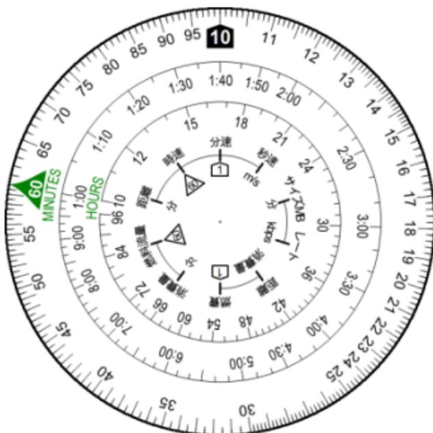
時間の計算をするときは、内目盛を時間の単位(分)として使います。内目盛の60分は、その内側にある補助目盛の1時間に対応しています。1～10時間までは時と分が混在しますが、10時間を超えてさらに内側の補助目盛に移ると、その後は10時間、100時間と容易に位取りすることができます。
